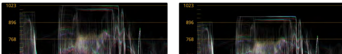
(Vlevo) Rozsah křivky zobrazený ve výchozích Data Levels, (Vpravo) Stejný průběh jako při zapnutém Video Level Scopes
